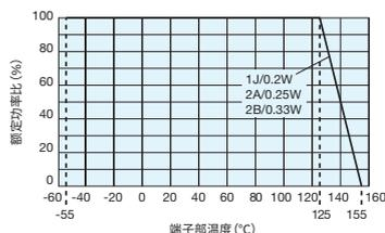
超过上述额定端子部温度使用时，请根据功率降额曲线减小额定功率后使用。
